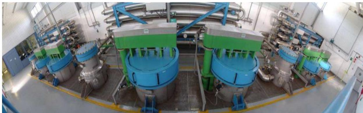
**Figura 1.** Planta industrial de tratamiento de corcho para eliminación de TCA con una capacidad de tratamiento de 2,500 toneladas por año, situada en San Vicente de Alcántara (Badajoz) (gentileza de Corchos de Mérida grupo Oneo Bouchage)
